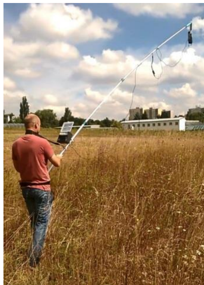
Obr. 2 Ověřování funkčního vzorku vyhledávací tyče s termovizí
