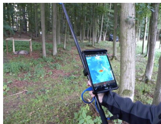
Obr. 5 Zobrazení srnčete z obr. 6 na monitoru zařízení VMT-VUZT termovizi v paletě „láva“
