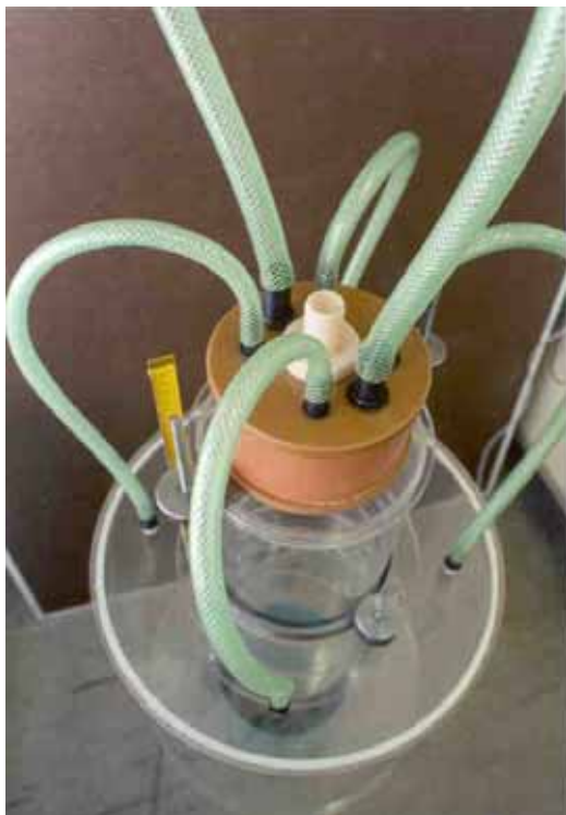
Obr. 3: Fermentor – detailní pohled na rozvod vzduchu do fermentoru
