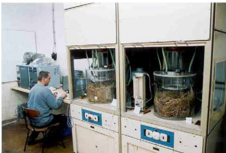
Obr. 6: Měření emisí amoniaku z podestýlky ve fermentorech
